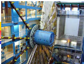
写真①: 地下実験場ではTGCセクターは前後方の壁構造を利用して順次結合されてビッグホイールに組み上げられた。
